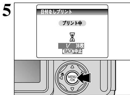
“MENU/OK” ボタンを押すとデータが転送され、指定された枚数のプリントが開始されます。続けてプリントするには手順 4、5 を繰り返します。プリントが完了したら “BACK” ボタンを押してください。
